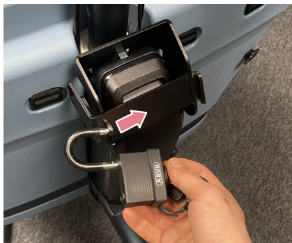
Figure 3 - Mise en place du verrou
